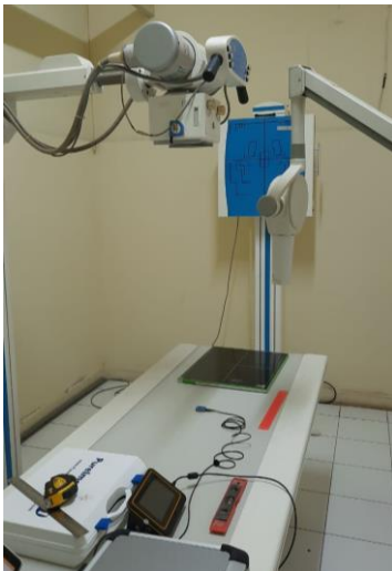
Gambar 1. Pesawat sinar-X radiografi umum terpasang tetap di ruang Radiologi Klinik Pratama ITB.
