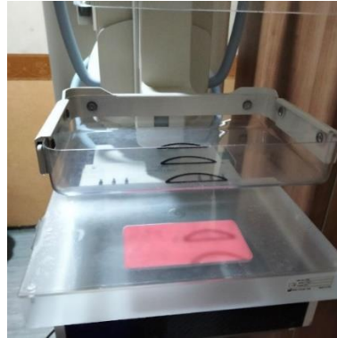
Gambar 1. Penampakan Phatom Mammografi digital ACR yang sedang diujikan pada pesawat mammografi
